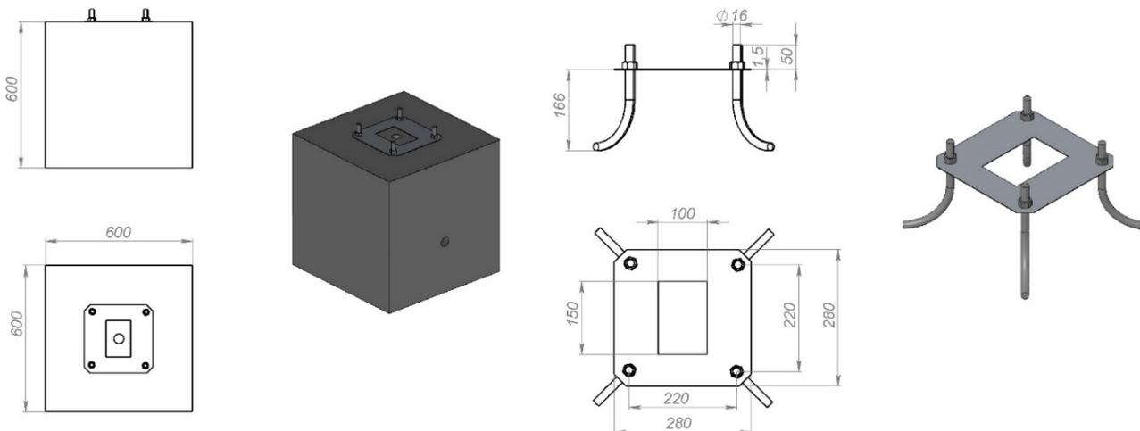
Шлагбаум следует установить на фундамент размером 600x600x600 из бетона марки не ниже С25-30 ХС4 XF4. При заливке необходимо использовать монтажный комплект: монтажную пластину и шпильки, при этом каждая шпилька должна выступать над поверхностью фундамента своей резьбовой частью на высоту не менее 50 мм.
